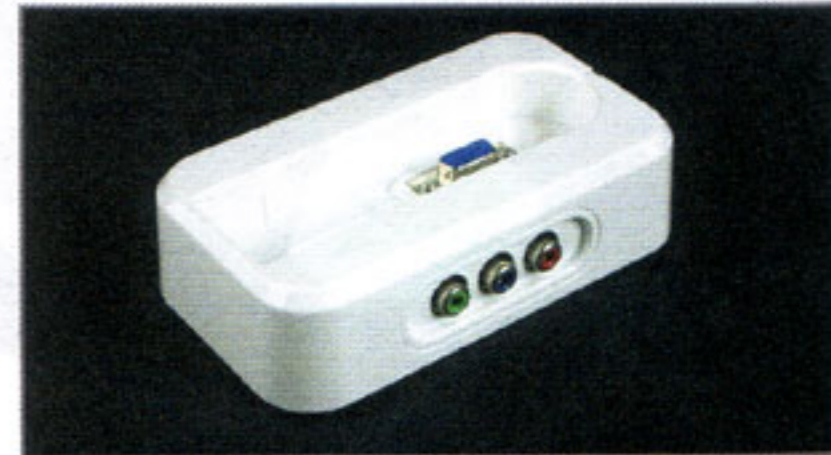
●透過底座加入視訊輸入功能，一邊為 Composite 及 S-Video 的輸入，另一邊為色差輸入。
