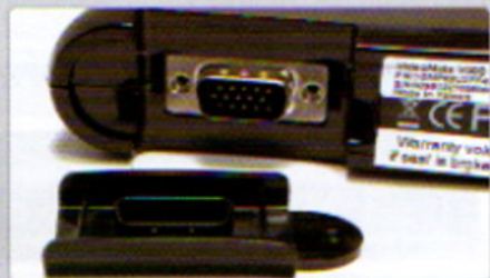
本體連接底座採用 D-Sub 接頭
